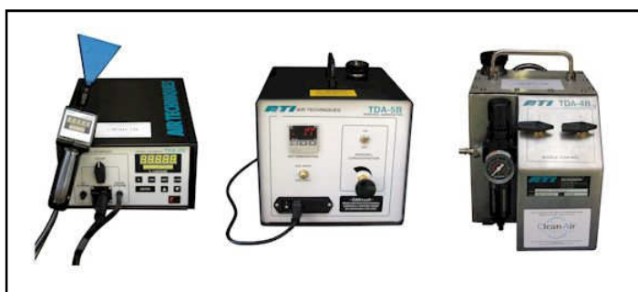
Aperçu des appareils de mesure utilisés pour le test d'intégrité des filtres.
