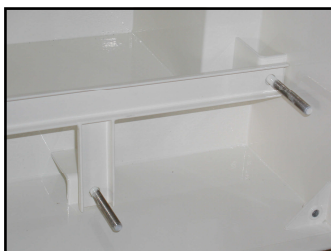
Vue des profilés de serrage mécanique du filtre
